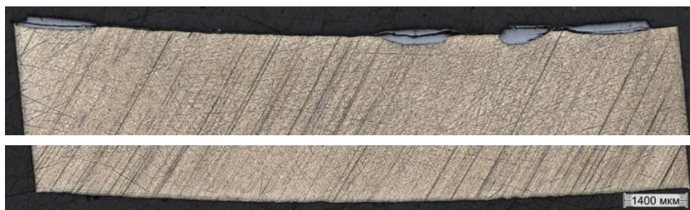
Рисунок 23 – Нодулярная коррозия трубы участка из зоны с максимальным значением флюенса (участок №2)
