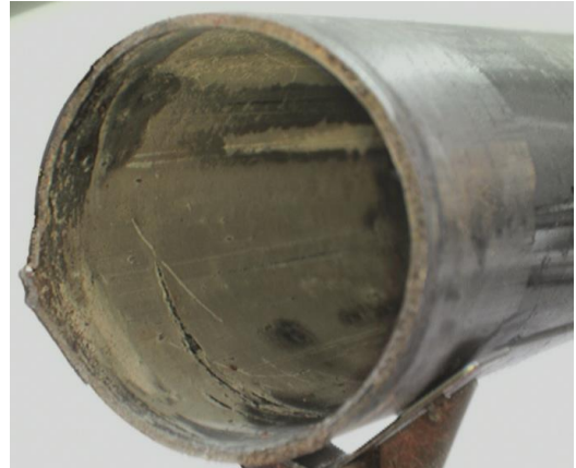
Рисунок 33 – Внешний вид участка дефектного канала СУЗ с нижним переходником (слева) в зоне технологического разрушения, труба канала с зоной ЭЛС справа
