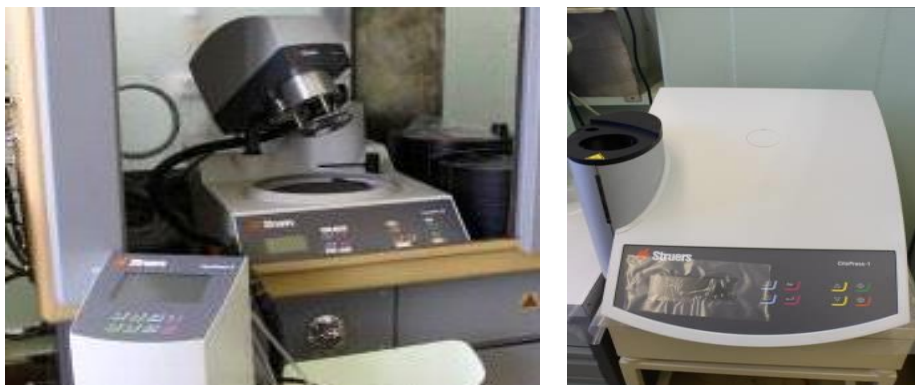
Рисунок 3 - Шлифовальный станок для пробоподготовки.
