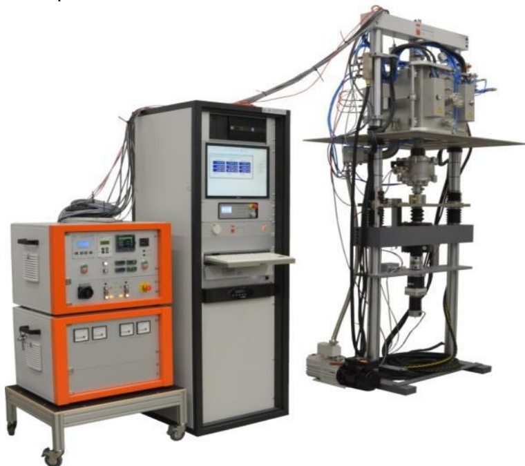
Рисунок 4 – Разрывная машина типа LFMZ 50kN с вакуумной камерой
